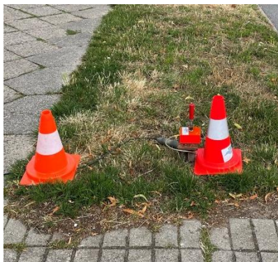
Abbildung 3-1: Am Erdreich angekoppelter Geschwindigkeitsaufnehmer (MP 1)
